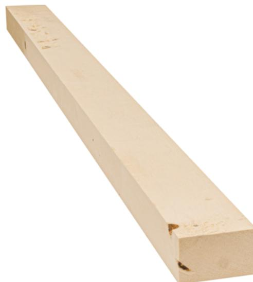
Bei Nadel-schnittholz handelt es sich aufgrund des heimischen Vorkommens vorwiegend um Fichte, Tanne und Kiefer. Schnittholz für Bauzwecke ist parallel besäumt oder prismiert mit sägerauer Oberfläche und annähernd rechteckigem Querschnitt. Die Qualiäten für Schnittholz umfassen lt. ÖHHU für sägefallende Ware die Klassen 0-III, für Bauware die Klassen III/V. Für den Einsatz als Bauschnittholz für tragende Zwecke muss nach DIN4074-1 sortiert werden und entsprechend mit CE gekennzeichnet werden.
