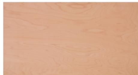
Sperrplatten Buche der Premium – Linie zeichnen sich durch eine harte, stabile Oberfläche, hohe Festigkeit und Formstabilität aus. Bei Abrieb und Verschleiß liefert dieses Sperrholz um 1/3 bessere Werte als Birken-sperrholz.
