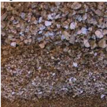
Das hellbeige Vermiculite ist federleicht und weist dank Millionen eingeschlossener Luftzellen gute Isoliereigenschaften auf. Durch das Expandieren wird Vermiculite steril, bakterien- und keimfrei.
