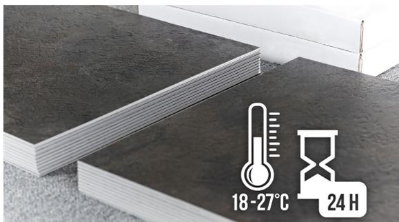
Verlegung nicht akklimatisierter oder Elemente mit niedrigen Temperaturen sind weniger biegsam und lassen sich weniger gut verarbeiten. Bei zu niedrigen oder zu hohen Temperaturen besteht die Gefahr der Beschädigung des mechanischen Verriegelungssystems. Ebenso besteht die Gefahr der Fugenbildung.
