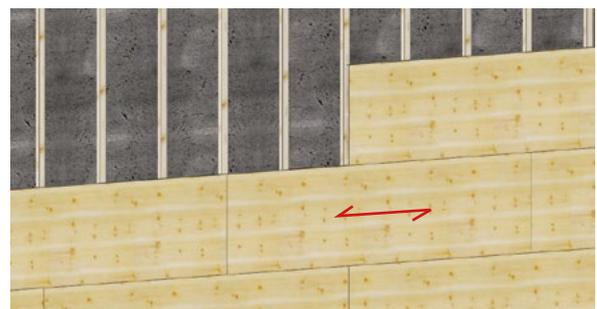
Senkrechte Konstruktion (Wand) – horizontale Anordnung
