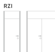
Raumhohe Zarge ohne Querteil und ohne Kämpfer, mit Oberblende bis Raumlichte von 2.600 mm (einflügelig, zweiflügelig)
