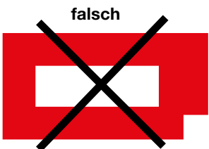
AUSFRÄSUNGEN IN DER FUNDERMAX COMPACT PLATTE
