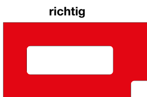
AUSFRÄSUNGEN IN DER FUNDERMAX COMPACT PLATTE
